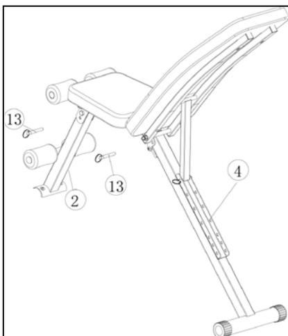
ШАГ 2: Разверните переднюю опорную стойку (2), вставьте штифт (13) в отверстие в месте соединения. Разверните заднюю опорную стойку (4), вставьте штифт (13) в отверстие в месте соединения.
