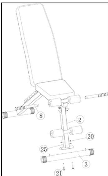
ШАГ 3: Возьмите передний стабилизатор (3) и подсоедините его к передней опорной стойке (2), после чего зафиксируйте конструкцию при помощи болта (21), дуговой шайбы (25) и гайки (20). Установите на поручень (8) тренажёра поролоновые накладки.
